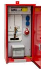
**MO-ZV-M 035**, zählerverteilerschrank, D02/35A, 1x Zählerplatz, 3x Schuko 16A, 1x CEE5x16A, 1x CEE5x32A, 1x FI40/0,03A, 390x750x300 mm, IP43, verzinktes Stahlblech
